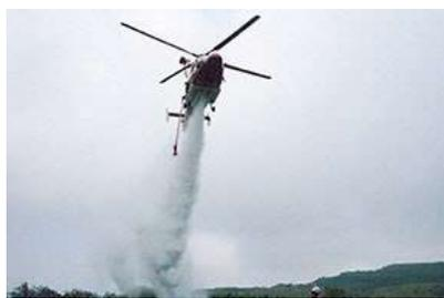
石けん系泡消火剤は、水のみで消火した場合と比べ、一般的に、使用する水の量を約半分に減らすことができる。また、他の消火剤と比較して、土壌での生分解性が早く、数日で90%が分解された結果が得られている。
